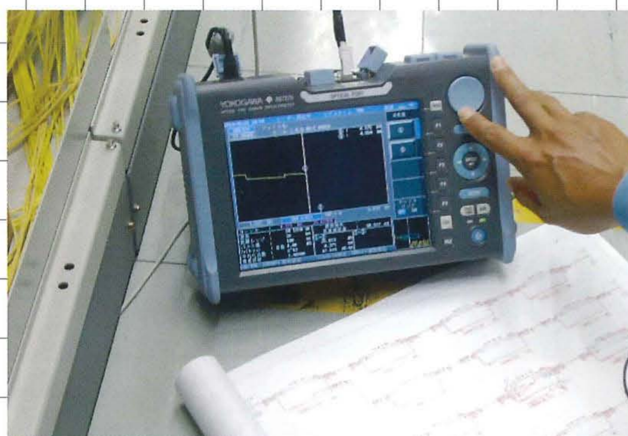
光ケーブル接続後確認試験をしている所 (パルス試験)
